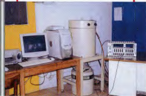
Συσκευή αέριας χρωματογραφίας με φασματογράφο μάζας (GC-MS).
