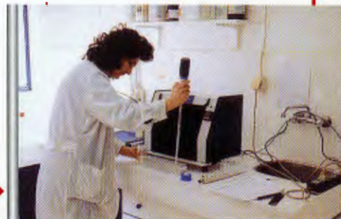
Συσκευή μέτρησης ρεολογικών ιδιοτήτων τυροπήγματος (Formagraph) ▶
