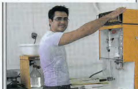
Συσκευή μέτρησης ρεολογικών ιδιοτήτων τυροπήγματος (Formagraph) ▶
