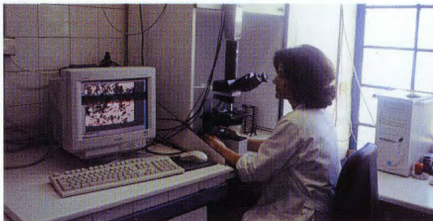
Οπτικό μικροσκόπιο με σύστημα αποθήκευσης και επεξεργασίας εικόνας (image analysis).
